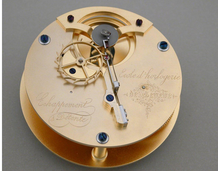
Fig. 8: Detent escapement engraved with Ecole d'horlogerie de Genève and Echappement à Détente . Musée d'art et d'histoire, Geneva. Inv. Number H 2008-122.
